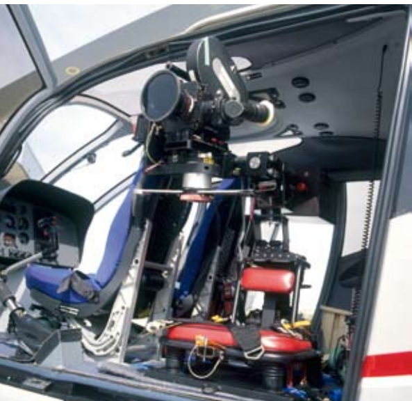
De Continental mt5-U mount met daarop de Arri 3. Mount en camerazijte staan door een ingenieus veerdempstelsel gemonteerd op de hardpoints van de helikopter.
